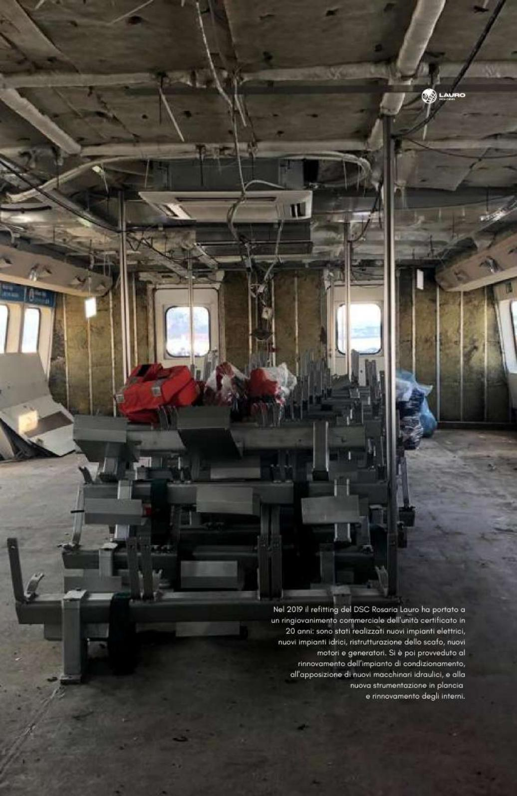
Nel 2019 il refitting del DSC Rosaria Lauro ha portato a un ringiovanimento commerciale dell'unità certificato in 20 anni: sono stati realizzati nuovi impianti elettrici, nuovi impianti idrici, ristrutturazione dello scafo, nuovi motori e generatori. Si è poi provveduto al rinnovamento dell'impianto di condizionamento, all'apposizione di nuovi macchinari idraulici, e alla nuova strumentazione in plancia e rinnovamento degli interni.
